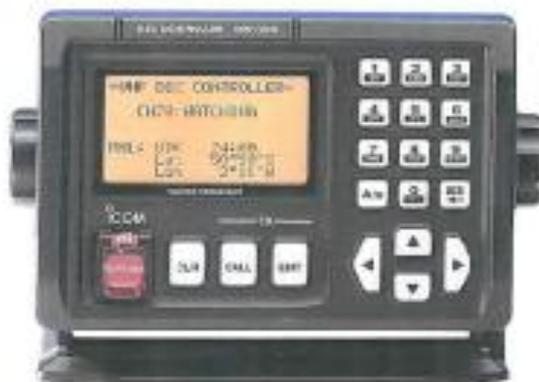
Le module ASN proposé par certains fabricants transforme une VHF classique compatible en une VHF avec Appel sélectif numérique pour accéder au canal 70 d'appels de détresse, de sécurité et de routine.
